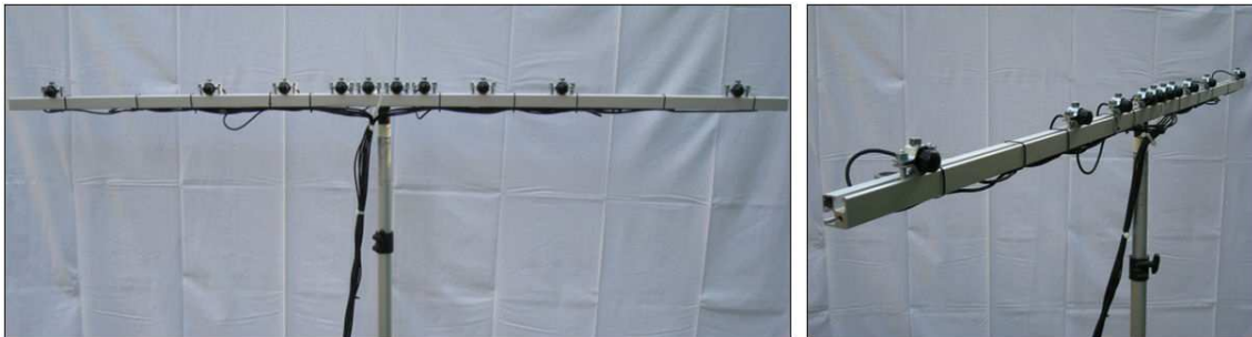
Figura 1 – Non-Uniform Linear Array (NULA) configurazione a 10 idrofoni
