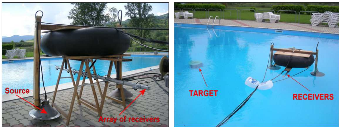
Figura 6 – Sonar attivo: sorgente e array di ricevitori (sinistra), set-up di misura nella piscina (destra)
