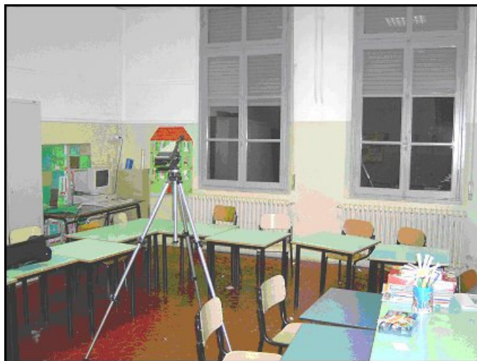
Fig. 2 – Posizionamento del fonometro per la misura interna.
