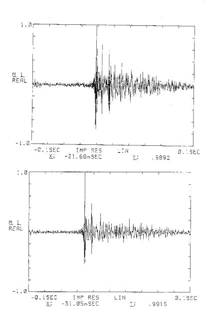
Fig. 2.16: Risposte all' impulso ottenute per deconvoluzione.
