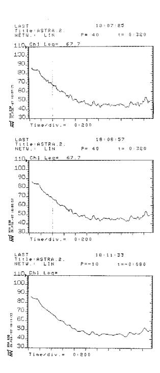
Fig. 2.9: Effetto dello "smoothing" sulle curve di decadimento.
