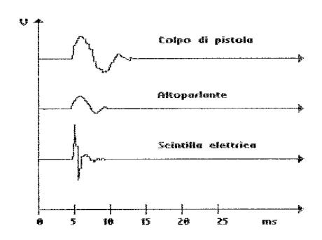
Fig. 2.14: Caratteristiche temporali delle sorgenti impulsive.
