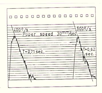
Fig. 2.5: Tracciati di decadimento di un rumore impulsivo
