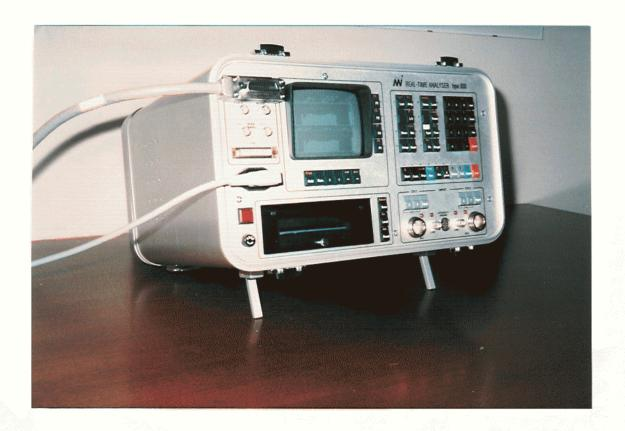
Fig. 2.8: Analizzatore di frequenza in tempo reale.
