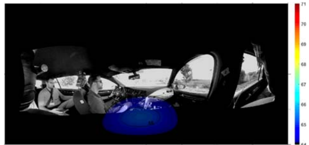
Fig. 14. SPL color map 70 Hz – 330 Hz, HSA, RNC-on.
