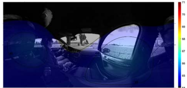
Fig. 12. SPL color map 70 Hz – 330 Hz, Eigenmike32™, RNC-on.
