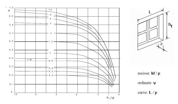
individuare sull'asse delle ascisse del grafico il valore hf/p; quindi tracciare la retta verticale fino ad incontrare il punto di intersezione con la curva corrispondente al valore di L/p precedentemente determinato. Da quest'ultimo punto si traccia la retta orizzontale che individua sull'asse delle ordinate il valore del coefficiente di riduzione ψ;  $\Box$  calcolare il fattore finestra  $\varepsilon$  secondo il tipo di ostruzione eventualmente presente.
