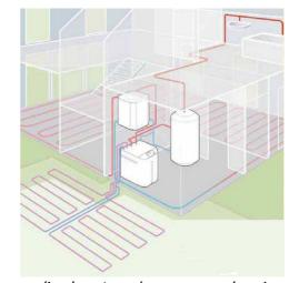
Pompa di calore acqua di falda/acqua
