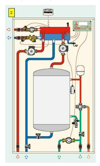
Tipologie di satelliti di utenza: n. 1 – solo riscaldamento con regolazione mediante valvola a 3 vie; n. 2 – riscaldamento e produzione di ACS con accumulo integrato su specoli;
