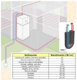
Pompa di calore terra/acqua a sonda verticale
