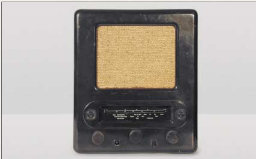
SIEMENS - Mod. VE 301 DYN a reazione - 3 valvole -
