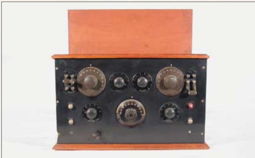
AUTOCOSTRUITA a reazione - 4 valvole
