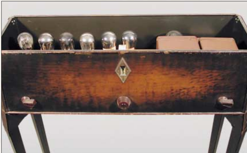
RADIOLA 33 7 valvole - alimentazione in alternata - 1927
