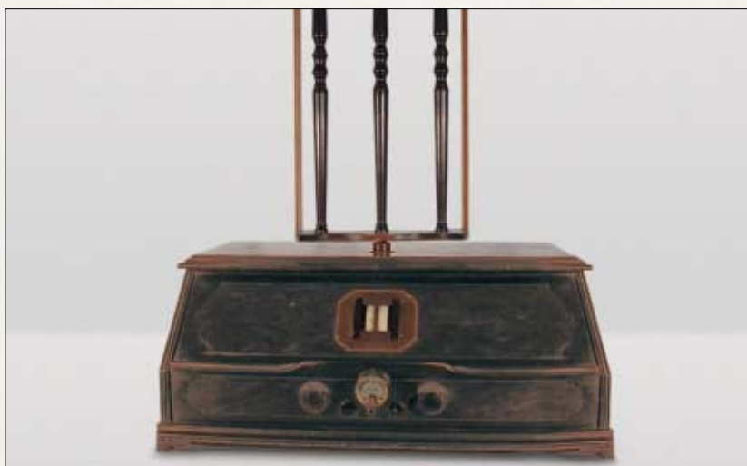
RCA - RADIOLA 25 Supereterodina con antenna propria
