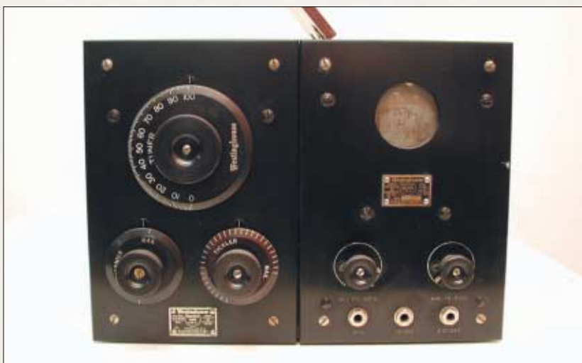
WESTINGHOUSE tipo RA. 2 sezioni : tuner + detector/amplifier
