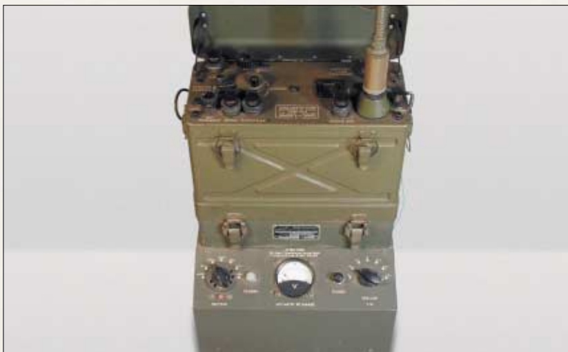
BC 1000 - U.S.A. Ricetrasmittitore di bassa potenza :40-48 MHz
