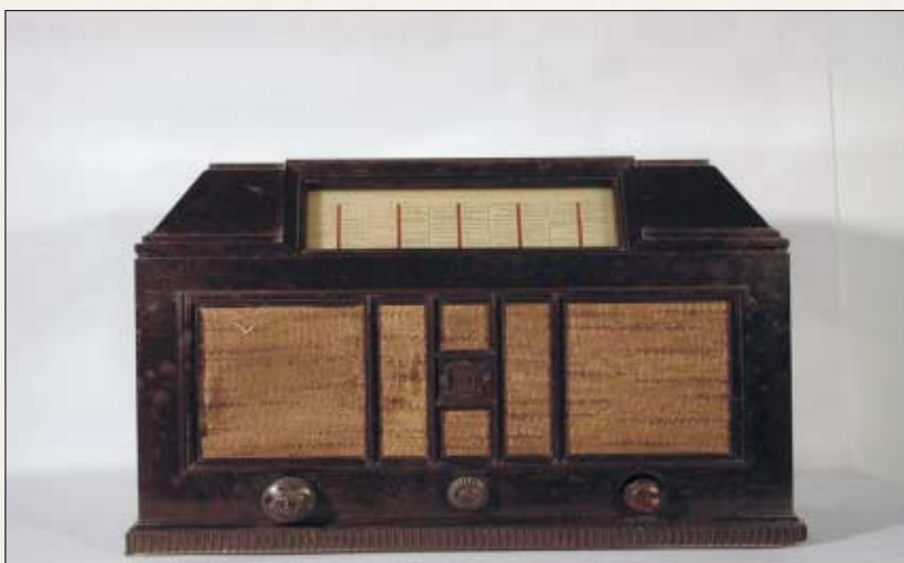
TELEFUNKEN - mod.346 GL "ADMIRAL" 4 valvole alimentazione da rete in c.c.
