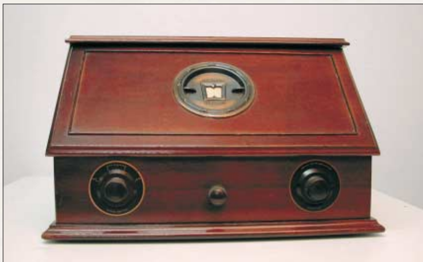
MARCONIPHONE TIPO 32 3 valvole - a reazione - U.K. - 1928
